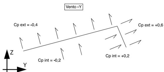
Tutte le azioni desunte dall'analisi dei carichi verranno convertite in carichi lineari agenti sulla struttura portante in acciaio da sottoporre a verifica.
