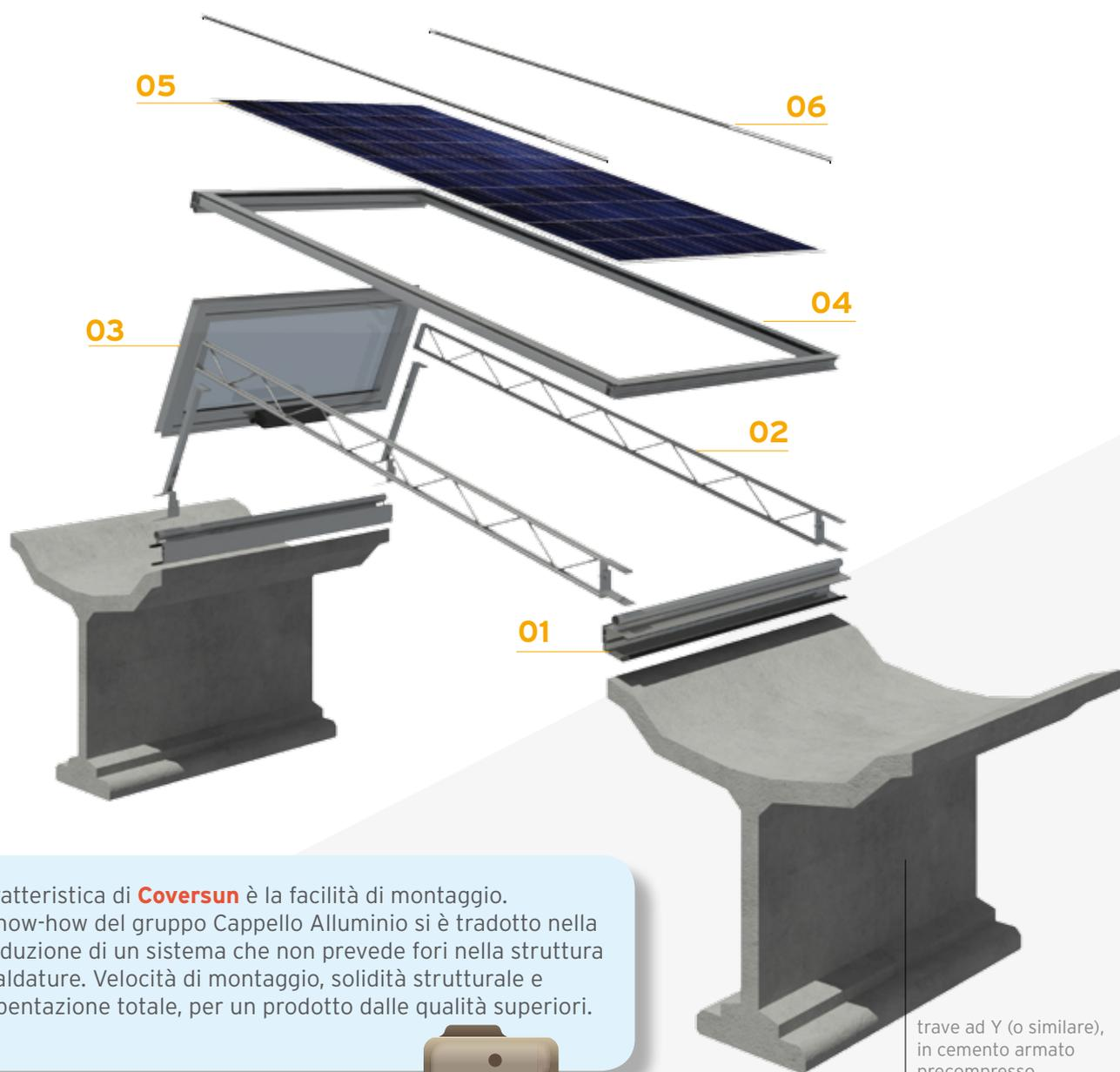
Caratteristica di **Coversun** è la facilità di montaggio. Il know-how del gruppo Cappello Alluminio si è tradotto nella produzione di un sistema che non prevede fori nella struttura e saldature. Velocità di montaggio, solidità strutturale e coibentazione totale, per un prodotto dalle qualità superiori.
